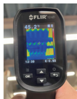
サーモグラフィカメラによる遮熱効果の測定 (12:30頃)
