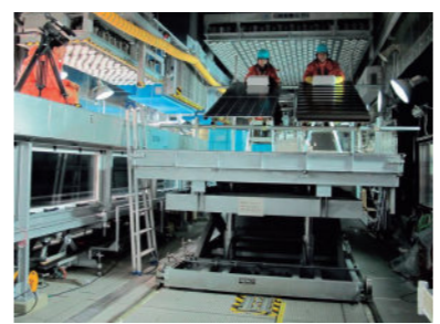
太陽電池パネルとトタン屋根の雪の同時滑走実験 (防災科学技術研究所 プレス発表: 2011年12月)
